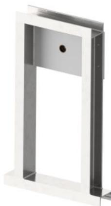
Рисунок 5.1 – 3D модель конструкции верхней части станины кривошипного пресса
