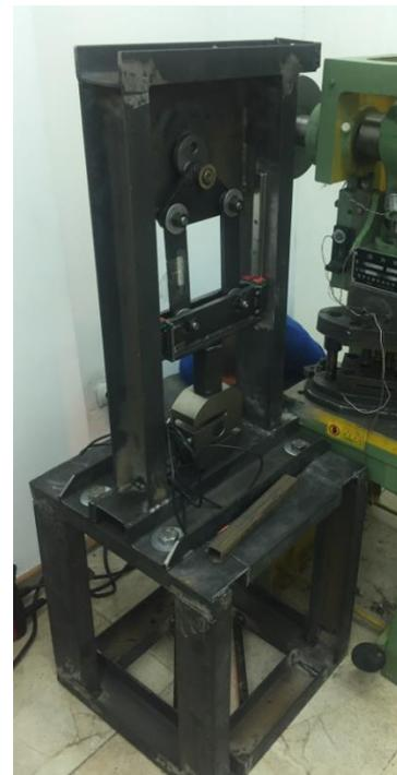
Рисунок 5.10 - Опытный образец кривошипного пресса с ГРМ на базе шестизвенного рычажного механизма Стефенсона II
