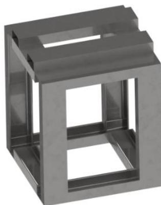
Рисунок 5.2 – 3D модель конструкции основания станины кривошипного пресса
